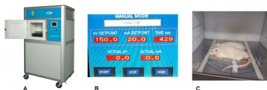
Figura 1: Irradiação dos animais: (A) Modelo do equipamento - RAD SOURCE - RS 2000 Pro Biological Irradiator. (B) Parâmetros usados na irradiação. (C) Posicionamento dos ratos para irradiação.
